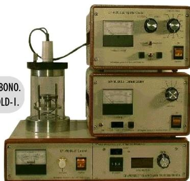
SISTEMA DE RECUBRIMIENTO ORO/CARBONO.
