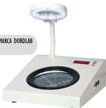
Indicado para contagem MARCA DORDLAB MOD. KJHV5 de colônias de bactérias ou fungos em placas de Petri de até 120 mm de diâmetro. Apresenta ótimas condições de iluminação e visibilidade, obtidas por meio de uma lâmpada circular fluorescente de 22 W e lupa de aumento de 1,5 vezes com haste flexível.
